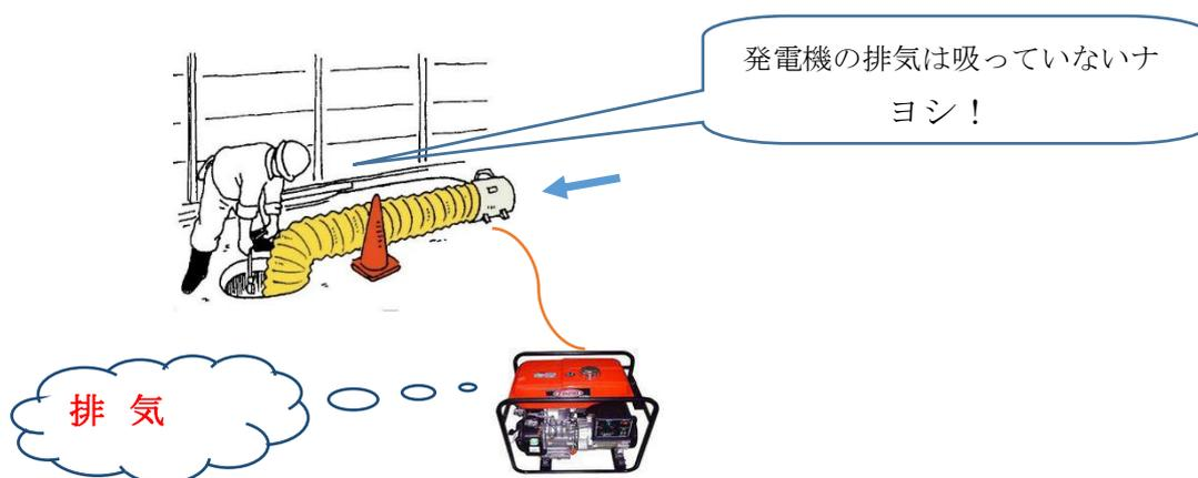
下水道（マンホール）内の点検作業時には、**酸素欠乏症等防止規則**に従い酸素濃度を測定し、危険がないか確認した後、安全のため移動式送風機で送気しながら作業を行うべきだが、送気した空気に一酸化炭素が含まれていたために作業員が軽度の一酸化炭素中毒（頭痛・吐き気）に被災する例が多い。
