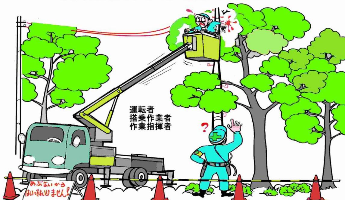
【発生状況】 樹木の剪定には、三脚やはしごを使用する機会が多いが、高所作業車が入手しやすくなり、運転操作も容易なため樹木の周りに高所作業車が入ることができれば、活用するケースが多く見られる。今回は、市道における街路樹の剪定作業に9m級のトラックマウント式伸縮ブーム型高所作業車が配置された。市道の部分は、カラーコーンにより交通規制を行い高所作業車や切り取った枝等を運ぶトラックを駐車させていた。歩道も影響が及ぶ範囲で、カラーコーンによる通行規制を行っていた。街路樹は、4～5mの高さで、その上に電柱を介して電線や、電話線が張られていた。作業において、これら架空線に纏わる事故が多いため、特に注意して作業は進められた。作業床として、剪定用の一人乗りバスケットにオペレーターが乗車し、樹木を一本ずつ剪定していた。事故は、樹木と電柱に挟まれた位置で発生した。電線の途中から引き込まれている電話線に気を取られ、剪定する位置を変えるため、旋回した時に反対側にあった電柱の突起物に腕をぶつけ負傷した。
