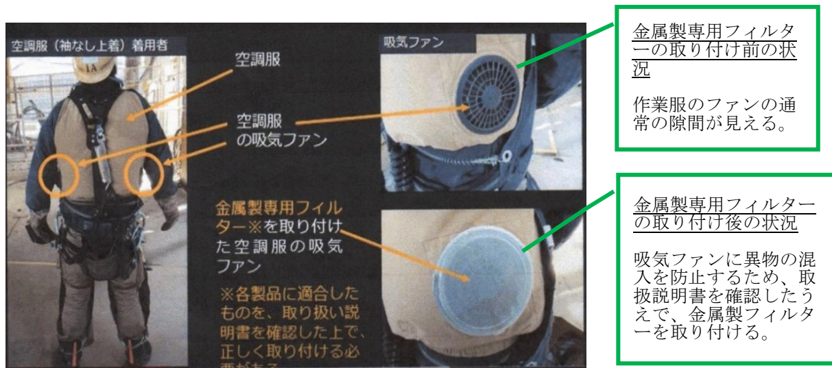
図2 金属製専用フィルター取り付け前と取り付け後の状況
